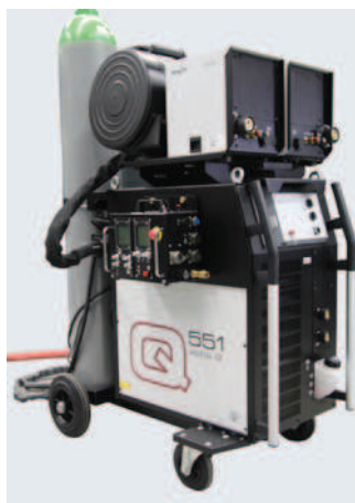
Orbitální systém pipeTruck MAG
